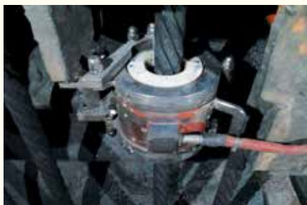
Рис. 6. Пример стационарной установки магнитной головки на канат
